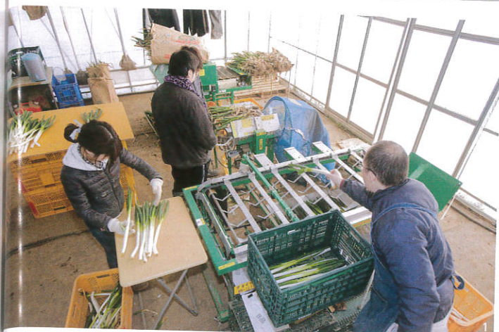
1.根・葉切り機(奥)にかけたネギを、専用皮剥き機(中)で皮を剥き、選別機(手前)にかけ機械化ライン。操作する利用者はすっかり手慣れている。2.3.こちらでは根と葉をカットしたネギの皮をコンプレッサーで吹き飛ばしている。コップがあるけれど達成感のある作業。4.レーザーのラインに合わせネギを根・葉切り機に置いていく。切りすぎるともったいないし、切り方が浅いと皮がうまく剥けず、むずかしい。
